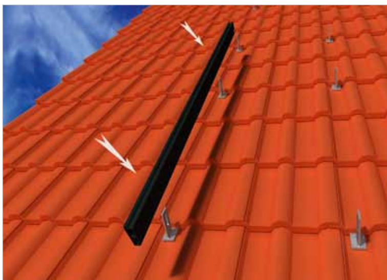
6 - Positionnement d'un profilé à gorge 2 C
